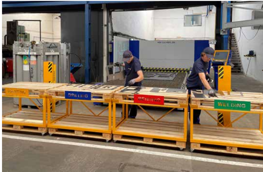
Obr. 5 Proces triedenia dielov po vyrezaní s pomocou vizuálneho sortovacieho asistenta. Diely sú triedené na rôzne palety podľa nasledujúcej pracovnej pozície.
