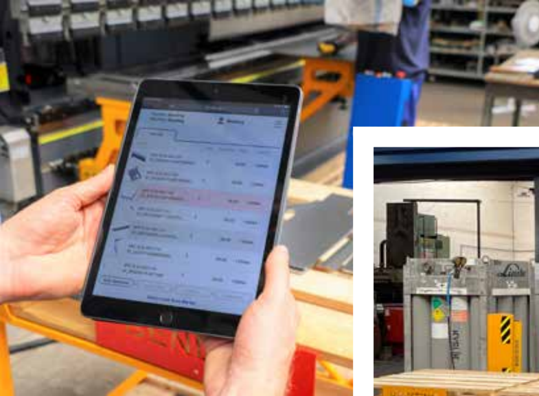
Obr. 4 Uživatelské rozhranie na tablete pre pracovnú pozíciu ohraňovania s ohraňovacím lisom MicroStep MSBend-S.
