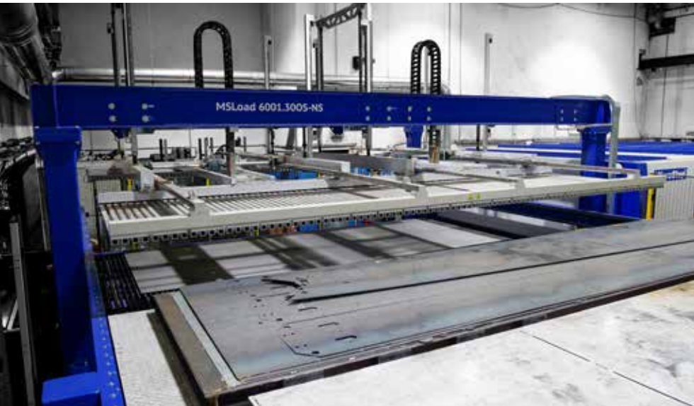
Obr. 1 Automatizované vykladanie vyrezaných dielov riadené aplikáciou CyberFab Manager (Taliansko).
