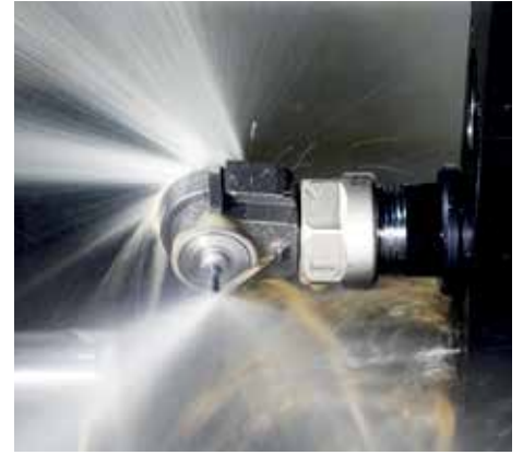
Obr. 5 Vysokorýchlostné vreteno TJS M90 ST z radu SPINJET poháňané chladiacou kvapalinou, je účinným nástrojom pre zvýšenie rýchlosti otáčok miniatúrnych rezných nástrojov.
