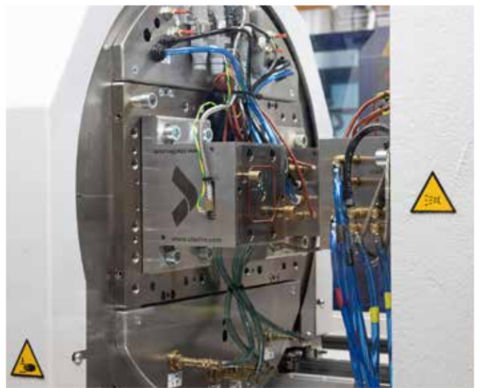
Otočný stôl s jednokavitovou formou na stroji MicroPower LIM.
