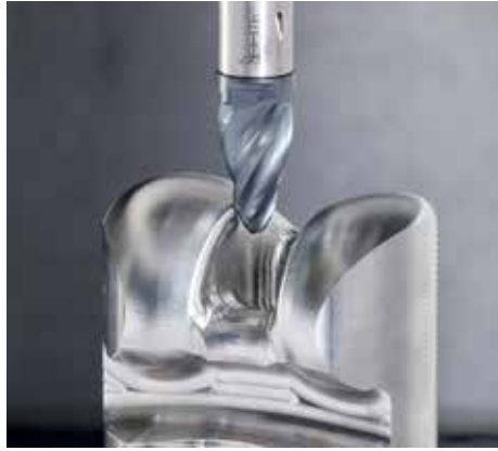
Obr. 4 Použitie barelových fréz výrazne skracaje dobu cyklu pri obrábaní súčastí kolennej protézy – na obr. vymeniteľná karbidová barelová hlavička MM EOB z radu NEOBARREL.
