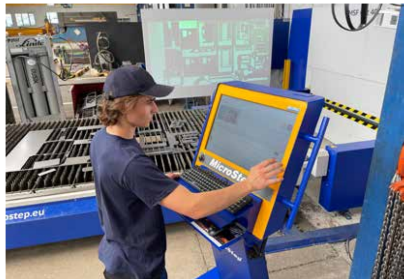
Obr. 3 Visual sorting guide – proces registrácie vytriedených dielov v systéme CyberFab Manager, s projekciou rezného plánu ako vizuálnou pomôckou pre operátora.
