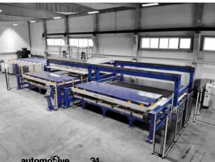
Obr. 2 Automatizovaná laserová linka s dvojitým nakladačom MSLoad Twin.
