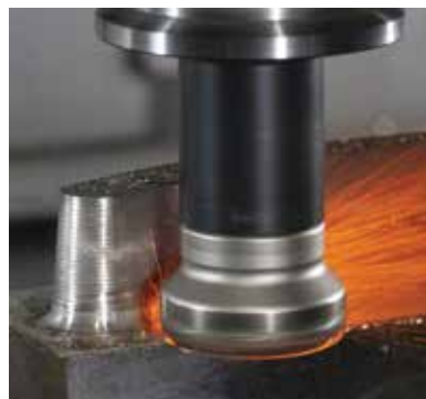
Obr. 3 Frézy s vymeniteľnými kruhovými doštičkami z keramiky poskytujú výrazne vyššie rezné rýchlosti pre vyššiu produktivitu.
