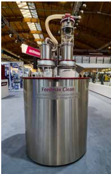
Vákuový nasávač WITTMANN Feedmax Clean – pre jednoduché a rýchle odprašenie recyklovaných plastových materiálov.
