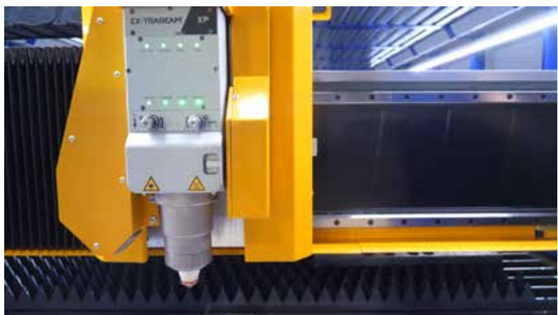
Karbónový portál stroja MSF Pro X od MicroStep.
