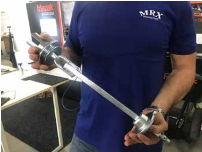
Kĺb so sklopným bezpečnostným madlom na nákladné vagóny vyrobený v MRX, s.r.o.
