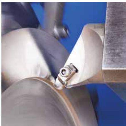
Obr. 1 Superzliatiny sú kľúčovými materiálmi pre prúdové a vrtulové motory moderných lietadiel. Turbína obrábaná systémom CUT-GRIP od ISCARu.
