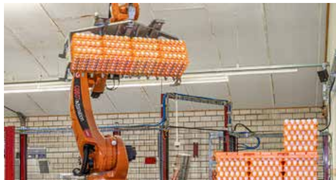
Plně automatická paletizace: robot KR QUANTEC dokáže najednou odebrat dvanáct naplněných plat vajec.
