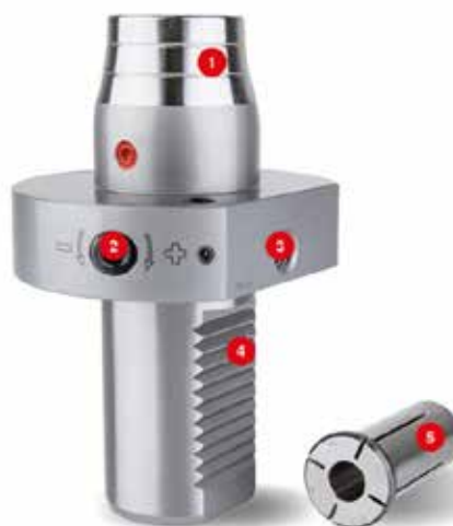
Hydraulický VDI upínač: 1 Tělo, 2. Šroub pro upnutí nástroje, 3. Aretační šroub vyvrtávací tyče, 4. Rozhraní VDI 30 a 40, 5. Redukční pouzdro
