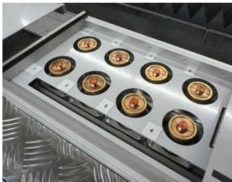
Stanica automatickej výmeny trysiek s ôsmimi pozíciami.
