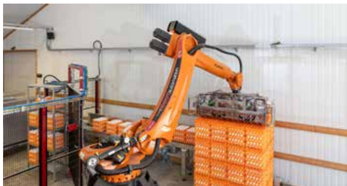
Chapadlo je navrženo tak, aby si poradilo i s materiály, jako je lepenka a plast.
