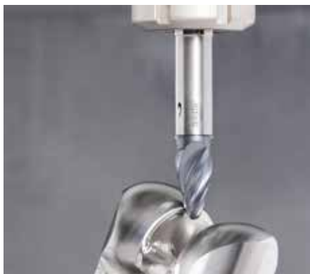
Obr. 2 Obrábanie implantátu femorálneho kĺbu pomocou vymeniteľnej MULTI-MASTER kužeľovej frézy.
