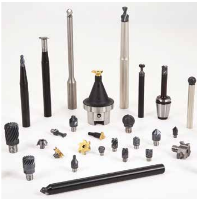
Obr. 2 Systém MULTI-MASTER umožňuje viac ako 40 tisíc kombinácií zostavení nástroja.
