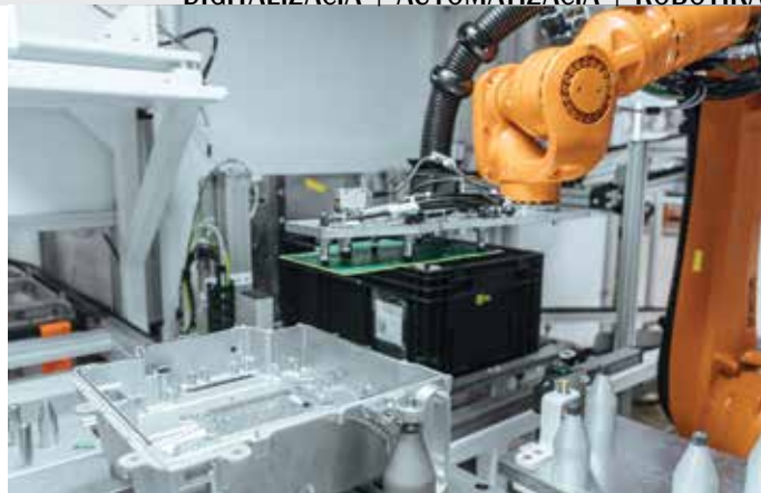
Přesná montáž: KR CYBERTECH vkládá vnitřní elektronické prvky do krytu řídicí jednotky elektromobilu.
