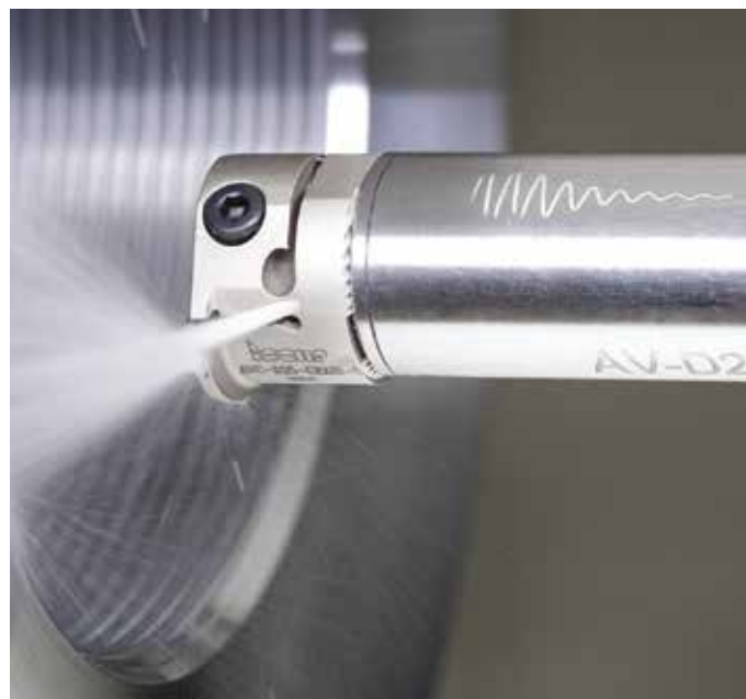
Obr. 3 Antivibračná tyč AV-D z radu WHISPERLINE pre vymeniteľné adaptéry.
